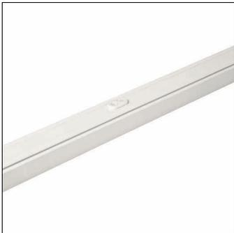
Modario®, alimentazione aggiuntiva, cablaggio interno, con 20 morsetti 2 volte 1,5..2,5 mm<sup>2</sup>, per alimentazione, cablaggio passante: 10x 2,5mm<sup>2</sup>, elemento canale portante, in acciaio, verniciato, bianco, 5x misura di sistema, lunghezza: 1.495mm, larghezza: 58mm, altezza: 43mm, grado di protezione (totale): per grado di protezione IP20, classe di isolamento (totale): classe isolamento I (messa a terra), marchi di qualità: CE, UKCA, unità d'imballo: 1 pezzo
