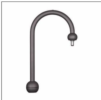
Large Bell, braccio arcuato da palo, braccio arcuato da palo, allineato, in acciaio, zincato, verniciato, ferro micaceo Siteco® (DB 702S), braccio singolo, con dispositivo di chiusura a baionetta, diametro: 89mm, altezza: 1040mm, imbocco: 76/89mm (su palo diritto), unità d'imballo: 1 pezzo
