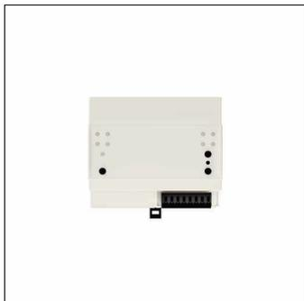
SITECO Connect 21-Ocontrôleur, maître, contrôle central, gradable, type de pose: encastré, emplacement de pose: dans un répartiteur électrique, en plastique, unités: 6 unités, degré de protection (total): IP20, classe de protection (total): classe de protection II (double isolation), marquage: CE, tension: 100..240V, type de tension: AC, 1 x connexion réseau Ethernet, 2 x DALI-2, unité d'emballage: 1 pièce
