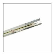
Modario®, rail, en tôle d'acier, laqué, blanc brillant, 5x dimension du système 299mm 10 conducteurs et 1x dimension du système 1495mm 2 conducteurs, longueur: 1.495 mm, largeur: 58 mm, hauteur: 43mm, câblage continu: 12x 2,5mm², avec borne, 10+2 broches, 2,5mm² max., degré de protection (total): pour un degré de protection IP20, classe de protection (total): classe de protection I (mise à la terre), marquage: CE, ENEC, VDE, norme: EN 60598, unité d'emballage: 1 pièce
