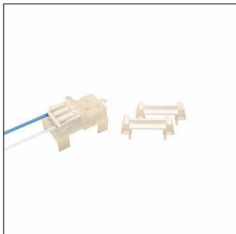
Modario®, câblage continu, type de pose: encastré, câblage supplémentaire, 2 conducteurs, 1,5mm<sup>2</sup>, câblage continu: 2x 1,5mm<sup>2</sup>, longueur du câble: 1,6m, borne, 3 broches, 2,5mm<sup>2</sup> max., marquage: CE, UKCA, unité d'emballage: 1 jeu
