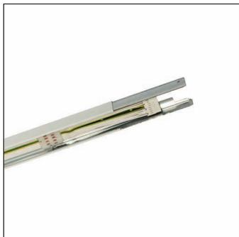
Modario®, rail, en tôle d'acier, laqué, blanc brillant, à deux longueurs, longueur: 2.990 mm, largeur: 58 mm, hauteur: 43mm, câblage continu: 10x 2,5mm<sup>2</sup>, avec borne, 10 broches, 2,5mm<sup>2</sup> max., degré de protection (total): pour un degré de protection IP20, classe de protection (total): classe de protection I (mise à la terre), marquage: CE, ENEC, VDE, norme: EN 60598, unité d'emballage: 1 pièce
