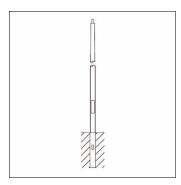
mât, mât, cylindro-conique, en St 37-2, thermolaqué, fer micacé Siteco® (DB 702S), hauteur: 5,0m, embout : 76mm (au sommet du mât), boîtier enterré: h= 800mm / Ø= 163mm, norme: DIN EN 40, unité d'emballage: 1 pièce
