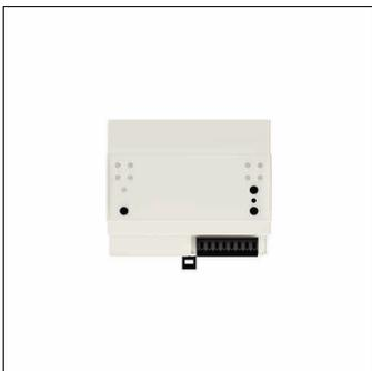
SITECO Connect 21-O controlador, maestro, control central, regulable, tipo de montaje: empotrado, lugar de montaje: en una distribución eléctrica, de plástico, unidades parciales: 6 unidades parciales, tipo de protección (total): IP20, clase de protección (total): SK II (a prueba de choques eléctricos), marca de verificación: CE, tensión: 100..240V, tipo de tensión: CA, 1 x conector de red Ethernet, 2 x DALI-2, unidad de embalaje: 1 unidad
