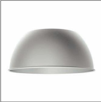
Highbay 31 S, reflector, control de luz directo con reflector, de aluminio, Alusoft, emisión de luz: directo haz, característica de iluminación directa: rotación simétrica, tipo de montaje: montaje superficial, diámetro: 433mm, altura: 170mm, unidad de embalaje: 1 unidad
