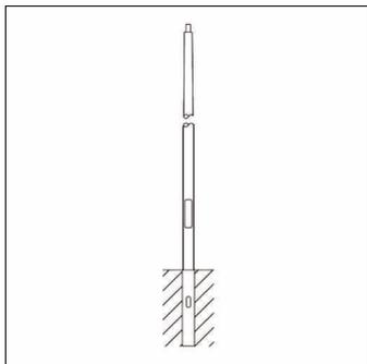
mástil, mástil, cónico redondo, de St 37-2, recubrimiento pulverizado, Siteco® gris metalizado (DB 702S), altura: 5,0m, espiga: 76mm (superior), sección plantada: h= 800mm / Ø= 163mm, norma: DIN EN 40, unidad de embalaje: 1 unidad
