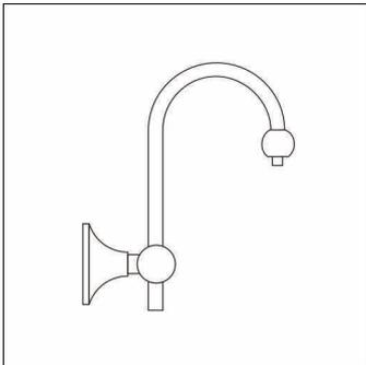
Small Bell, brazo de pared, brazo de pared, de acero, galvanizado, lacado, Siteco® gris metalizado (DB 702S), 1 brazo, con cierre de bayoneta, altura: 829mm, unidad de embalaje: 1 unidad
