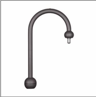
Bell grande, mástil arqueado, mástil arqueado, alineado, de acero, galvanizado, lacado, Siteco® gris metalizado (DB 702S), 1 brazo, con cierre de bayoneta, diámetro: 89mm, altura: 1040mm, espiga: 76/89mm (superior), unidad de embalaje: 1 unidad
