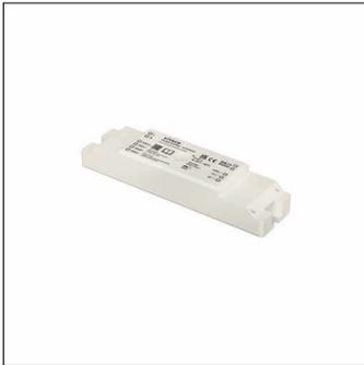
SITECO Connect 31 Officecontroller, slave, controllo locale, dimmerabile, tipo di montaggio: montaggio a incasso, luogo di montaggio: nel soffitto, in materiale plastico, grado di protezione (totale): IP20, classe di isolamento (totale): classe isolamento II (messa a terra), marchi di qualità: CE, tensione: 220..240V, tipo tensione: AC, 2 x ingresso tasti, 2 x DALI, unità d'imballo: 1 pezzo
