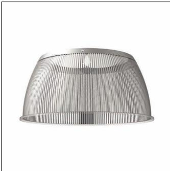
Highbay 31 S, riflettore, conduzione primaria della luce con riflettore, in PC, struttura prismaticata trasparente, uscita luce: a distribuzione diretta con schiarimento del soffitto distribuzione, distribuzione luminosa primaria: rotazionalmente simmetrico, tipo di montaggio: a plafone, diametro: 480mm, altezza: 227mm, unità d'imballo: 1 pezzo
