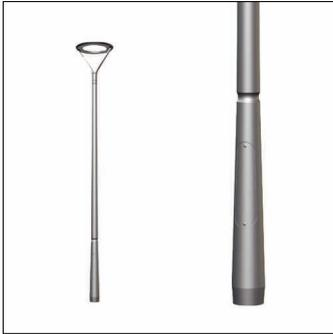
palo, palo, conico rotondo, in alluminio, verniciato, ferro micaceo Siteco® (DB 702S), altezza: 4,0m, imbocco: 76mm (su palo diritto), messa a terra: alt.= 800mm / Ø= 160mm, norma: DIN EN 40, unità d'imballo: 1 pezzo
