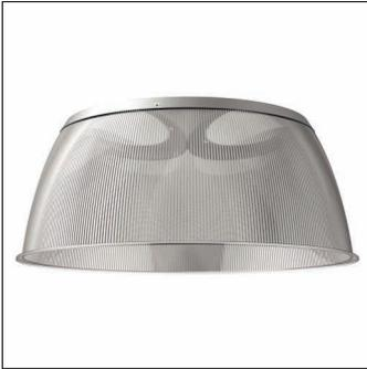
Highbay 31 L, réflecteur, orientation de la lumière primaire avec réflecteur, en PC, structure prismatique claire, diffusion de lumière: direct avec éclairage du plafond distribution, caractéristique d'éclairage primaire: symétrique en rotation, type de pose: en saillie, diamètre: 570mm, hauteur: 234mm, unité d'emballage: 1 pièce
