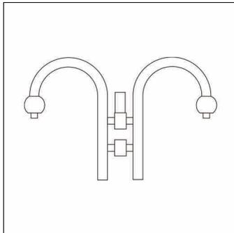
Small Bell, crosse, crosse, désaxée, en acier, galvanisé, laqué, fer micacé Siteco® (DB 702S), 2 bras, avec une baïonnette, diamètre: 76mm, hauteur: 829mm, embout : 76mm (au sommet du mât), unité d'emballage: 1 pièce
