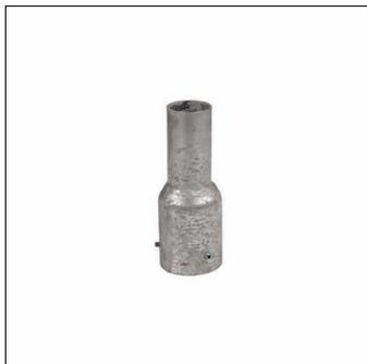
réducteur, type de pose: pose au sommet du mât, douille de réduction, en St 37-2, galvanisé, longueur: 230 mm, diamètre: 60 mm, embout : 76/60mm, unité d'emballage: 1 pièce
