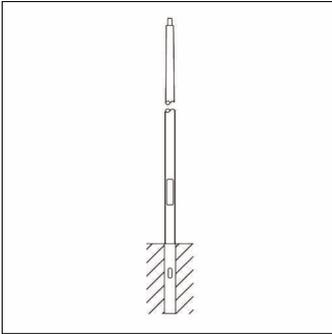
Mast, Mast, konisch rund, aus St 37-2, pulverbeschichtet, Siteco® eisenglimmer (DB 702S), Höhe: 6,0m, Zopfmaß: 76mm (Aufsatz), Erdstück: h= 1000mm / Ø= 178mm, Norm: DIN EN 40, Verpackungseinheit: 1 Stück
