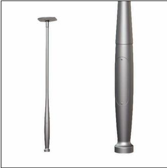
Mast, Mast, konisch rund, aus Aluminium, lackiert, Siteco® eisenglimmer (DB 702S), Höhe: 4,0m, Zopfmaß: 76mm (Aufsatz), Erdstück: h= 800mm / Ø= 140mm, Norm: DIN EN 40, Verpackungseinheit: 1 Stück
