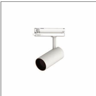
Spot 31 Slim, Richtstrahler, Lichtlenkung mit Reflektor, aus Aluminium, Entblendung mit Wabenraster, LED Bemessungslichtstrom: 2.200lm, Lichtfarbe: 930, Vorschaltgerät: EVG, mit 3-Phasen-Adapter, Netzanschluss: 220..240V, AC, 50/60Hz, Gehäuse, aus Aluminium, verkehrsweiß (RAL 9016), Durchmesser: 70mm, Adapter, aus Kunststoff, Schutzart (gesamt): IP20, Schutzklasse (gesamt): SK I (Schutzerdung), Prüfzeichen: CE, Schlagfestigkeit: IK02, Verpackungseinheit: 1 Stück
