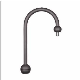
Kleine Glocke, Mastbogen, Mastbogen, fluchtend, aus Stahl, verzinkt, lackiert, Siteco® eisenglimmer (DB 702S), 1armig, mit Bajonettverschluss, Durchmesser: 76mm, Höhe: 829mm, Zopfmaß: 76mm (Aufsatz), Verpackungseinheit: 1 Stück
