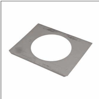
Lunis 11 R, Montage-Element, Montageart: Einbau, Montageplatte, Modul 625, aus Stahlblech, verzinkt, für 5LR610.., zur Abstützung des Leuchtengewichts am Tragwerk, Länge: 620mm, Breite: 500mm, Höhe: 25mm, Verpackungseinheit: 1 Stück
